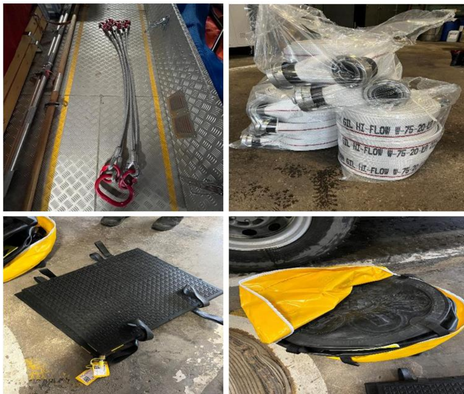
Zdjęcie 49. Zawiesia transportowe, węże pożarnicze, poduszki ciśnieniowe
