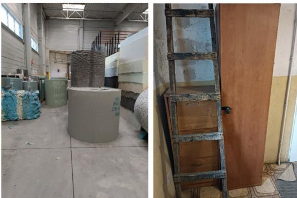
Zdjęcie 12. Pianka poliuretanowa oraz materiały drewniane składowane na drogach ewakuacyjnych
