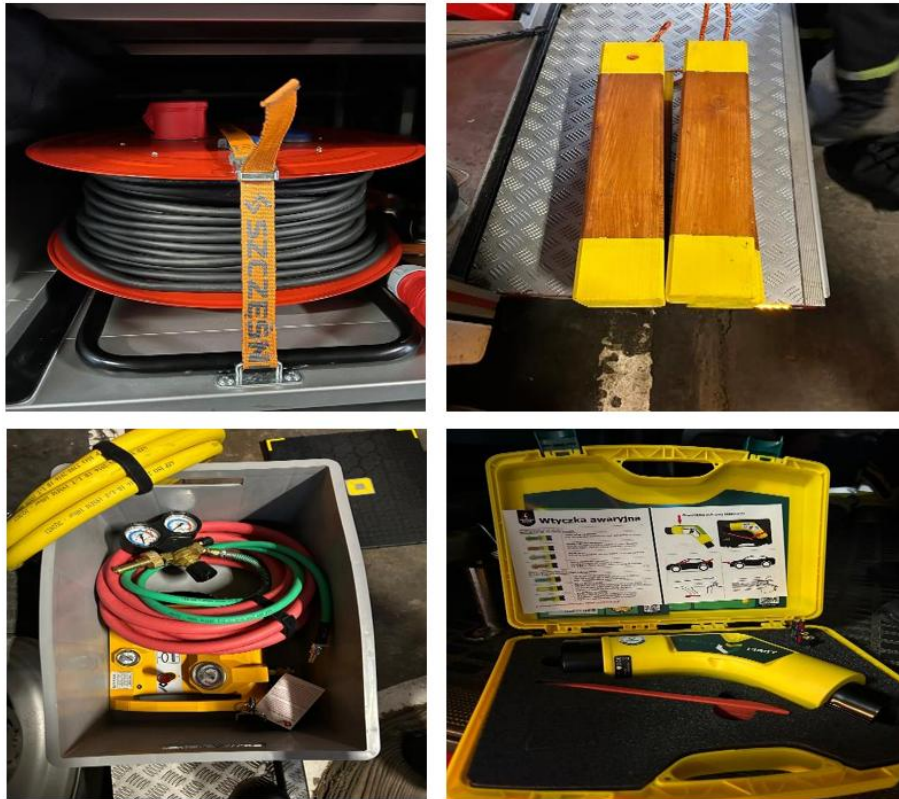
Zdjęcie 48. Przedłużacz elektryczny, zestaw klinów drewnianych, sterowniki oraz przewody do poduszek ciśnieniowych, wtyczka awaryjna do pojazdów elektrycznych
